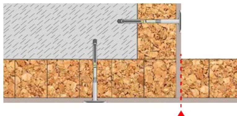
Figura 16 Realizzazione di angoli nel sistema Betontherm
